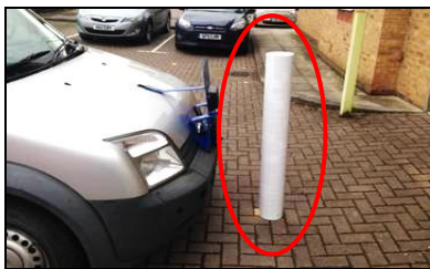
Bolardo de 1 m de largo enfrente de una cámara montada a 0,6 m
